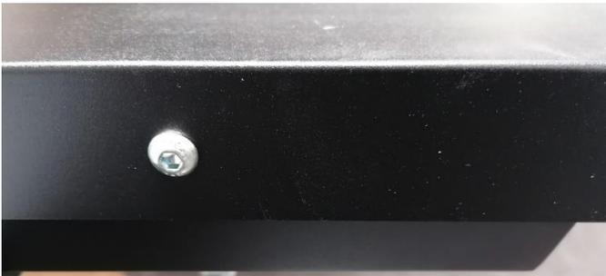
Die Steuerung inkl. Netzteil befinden unter einem Abdeckblech, welches mit vier Schnellverschluss-Schrauben befestigt ist, zum Lösen werden diese mit einem großen Schraubendreher um 90° gedreht. Zum Verschließen werden diese wieder hineingedrückt.
